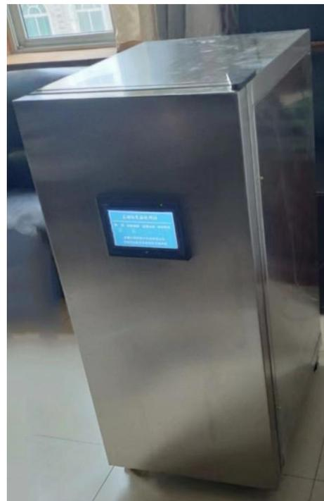
b. 化学反应CO<sub>2</sub>发生器
